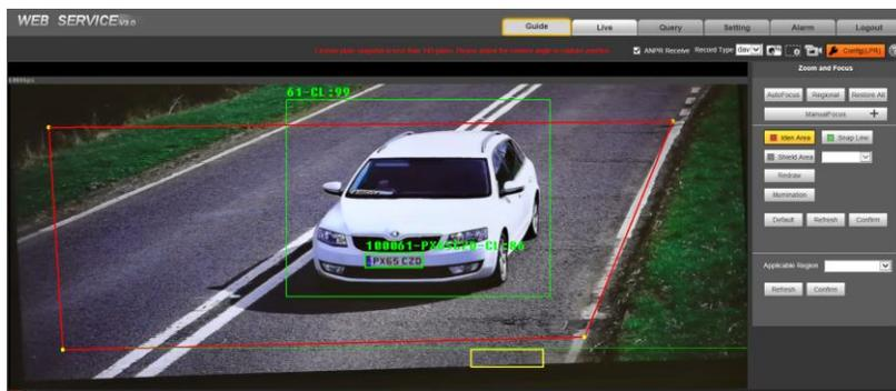
Fig. 8 : Configuration de la zone de détection.
