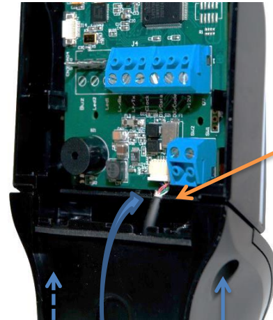
Encoche pour le passage du câble Biométrie Slot for the passage of the biometric cable
