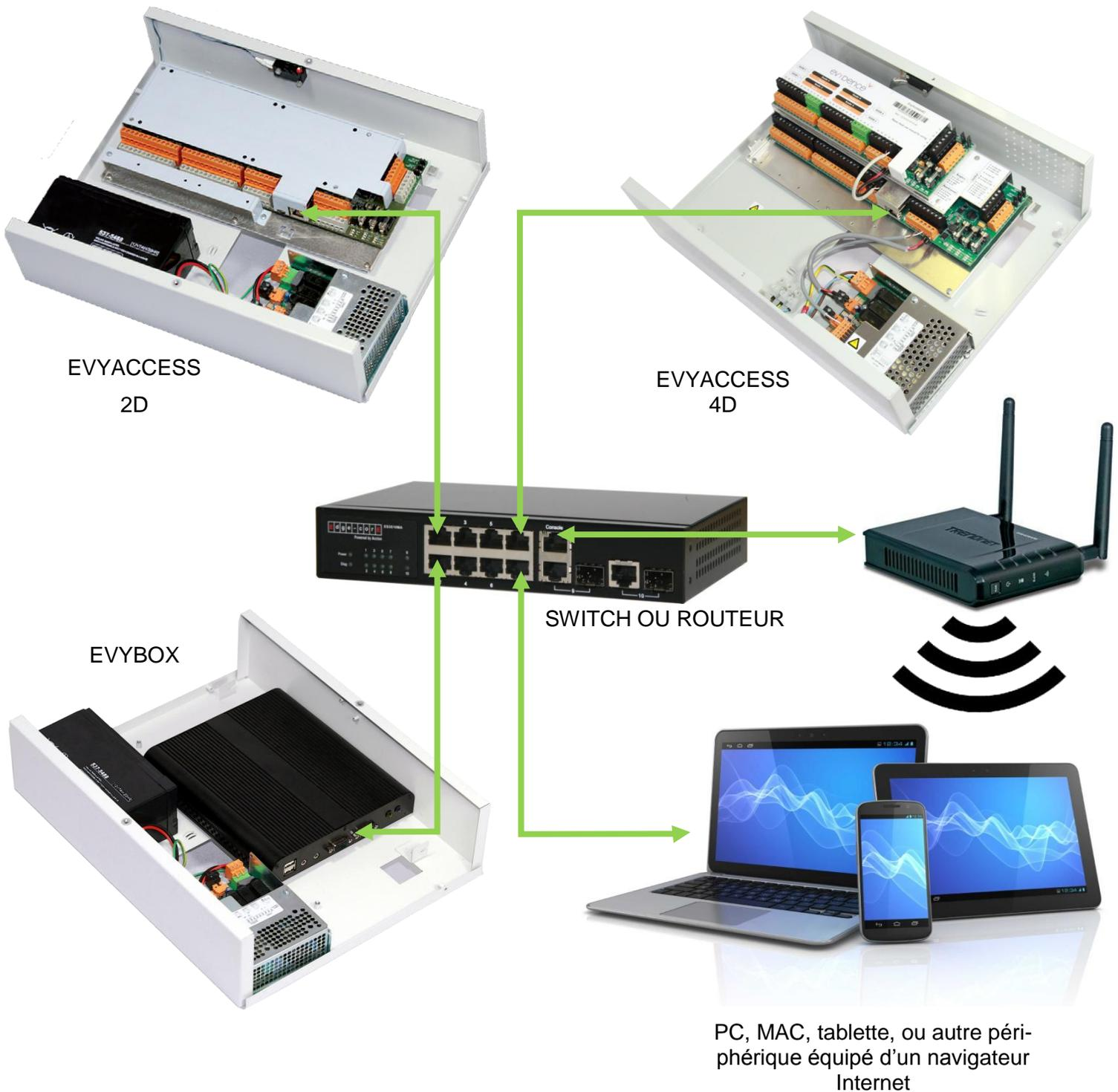
Veuillez utiliser un câble de type RJ45 Cat5e FTP blindé (ou F/UTP blindé).
