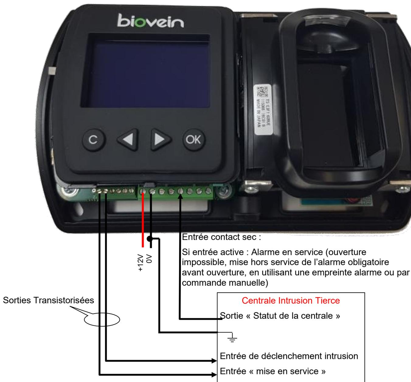
**Note :** Veillez à raccorder une masse commune entre le BIOVEIN et la centrale intrusion.
